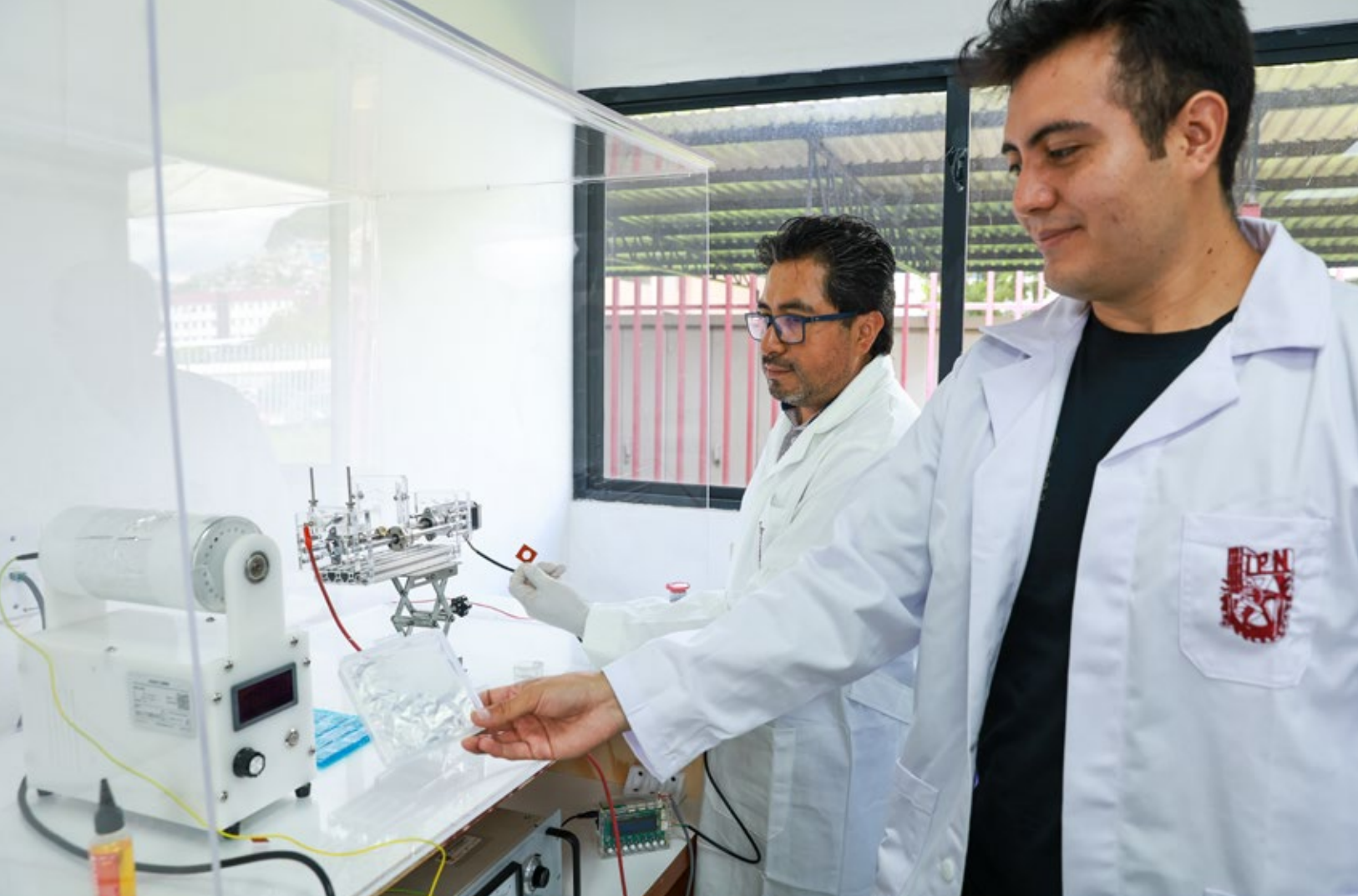
Encendido y sincronización del sistema de electrohilado con la solución polimérica y el colector rotativo
